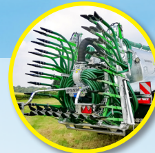
HYDRAULISCHE INKLAPFUNCTIE • BASIC: enkel (3 delen) • START: dubbel (5 delen)
